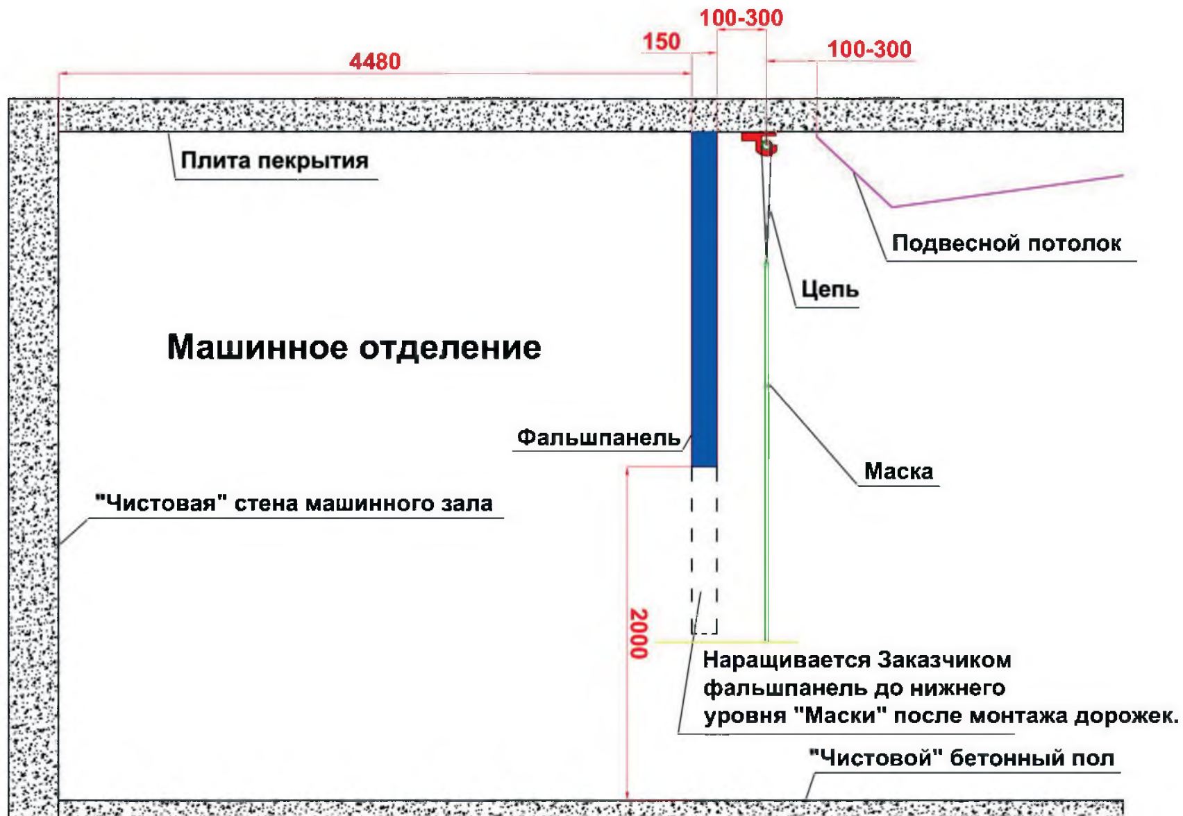
Рисунок № 10 - Пример установки фальшпанели и "Маски".
